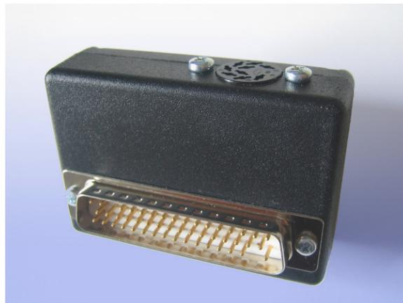
Mit diesem Adapter ist es möglich, die Studer Tonbandmaschine B67 mit der Kabel-Fernbedienung der B77 oder dem Infrarot-System B202/B203 und dem entsprechenden Fernsteuersender B201, B205 oder B208 in den Funktionen Play, Record, Vorspulen, Rückspulen und Stop zu steuern.
