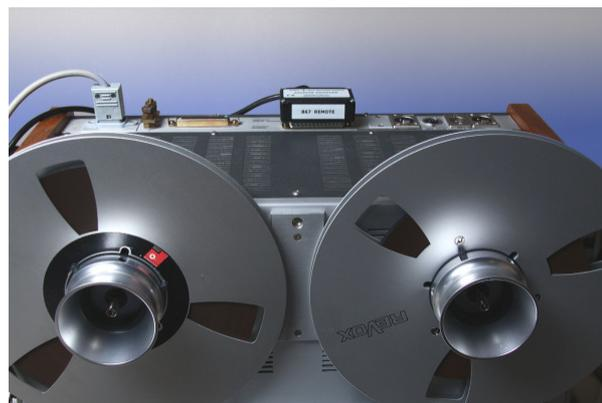
Da die Buchse zur externen Geschwindigkeitsregelung selten verwendet wird, wurde der Adapter so gestaltet, daß er diese Buchse verdeckt und nicht die Lüftungsschlitze. (siehe Bild)
